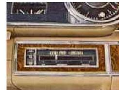
**Tempomat:** Erlaubt das Wählen einer bestimmten Geschwindigkeit. Der Tempomat wird ausgeschaltet, wenn die Zündung ausgeschaltet oder der manuelle Schalter auf „Off“ geschaltet wird. Er wird durch Betätigen des Bremspedals vorübergehend ausgeschaltet. Eine neue, rote Kontrollleuchte zeigt an wenn sich das System im Automatik-Betrieb befindet; bei eingeschaltetem Licht sind die Zahlen des Wahlschalters beleuchtet.
